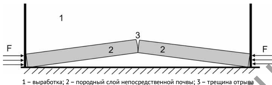
Рис. 2. Схема выпирания пород почвы Fig. 2. The scheme of bulging floors rocks
